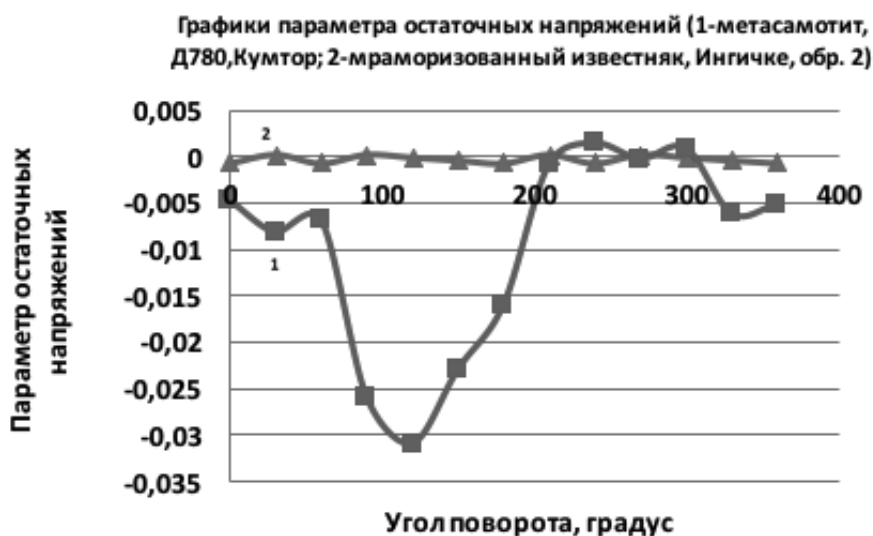
Рис. 2. Графики параметра остаточных напряжений в объеме образца метасамотита – 1 (Кумтор, 00 совпадает с направлением севера) и мраморизованного известняка - 2 (Ингичке) для разных направлений
