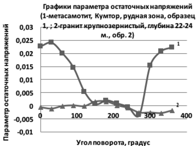
Рис. 3. Графики параметра остаточных напряжений в объеме образца метасамотита - 1 (Кумтор, 00 совпадает с направлением севера) и крупнозернистого гранита - 2 (глубина 24 м) для разных направлений
