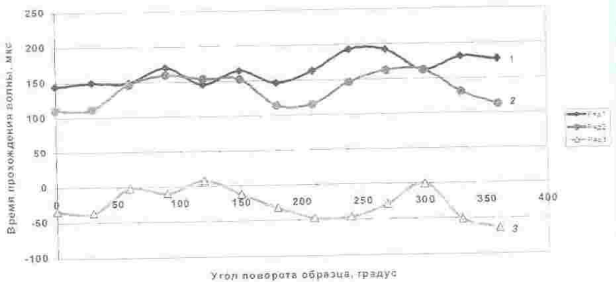
Рис. 4. Зависимости времени прохождения поляризованных поперечных волн (1-ВП; 2-ВС) и их разности (3-Т рп ) от угла поворота модели (призма, ЭД-6, обр.8 с наведенными остаточн. напряж., высота 100 мм, попер. размеры а=в=50 мм, диагональ D).
